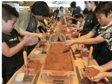
工場で行われている作業を実際に体験。砂・粘土・水を混ぜ合わせた「鋳物砂」にペーパーウェイトの型を入れ押し固め、溶かした金属を入れる型を作る。粘土遊びのようで楽しいが慎重さも要求されます。
